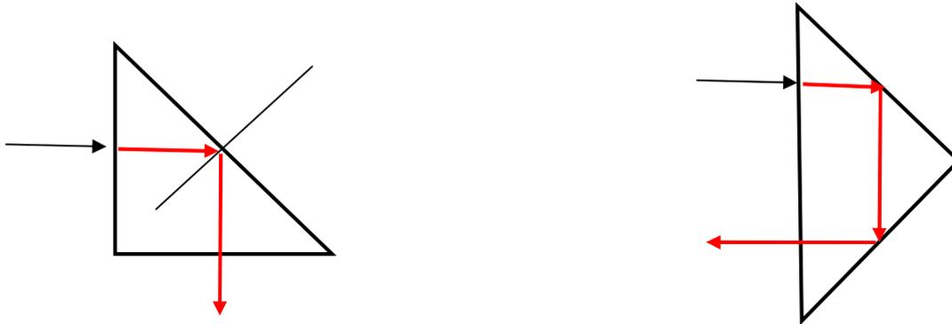
Conclusion : Ces prismes forment *des miroirs* et leurs fonctions optiques sont : *de couder le faisceau, pour redresser l'image ou diminuer l'encombrement du système optique.*
