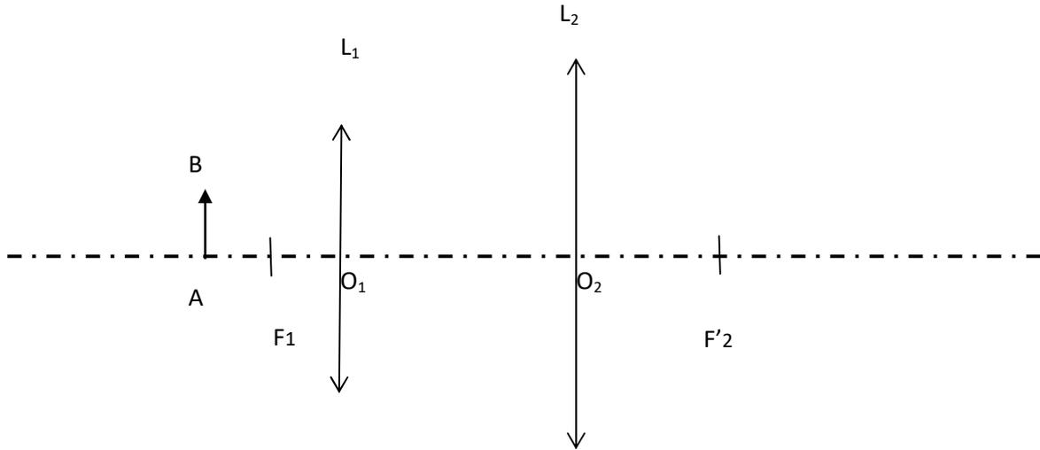
**II. Déterminer le faisceau issu de B limité par la monture de la lentille L1.**
