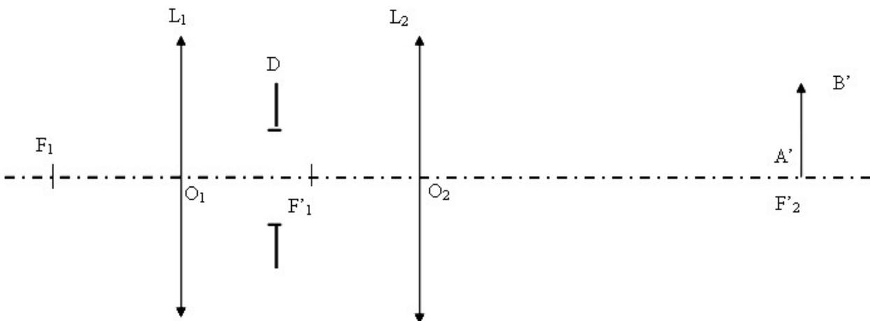
**V. Déterminer le faisceau issu de B limité par le diaphragme D. ( Suite)**
