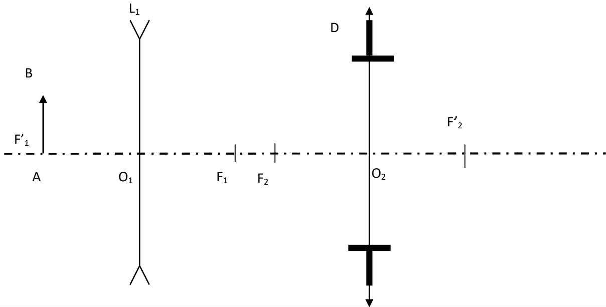
**IV. Déterminer le faisceau issu de B limité par le diaphragme D.**
