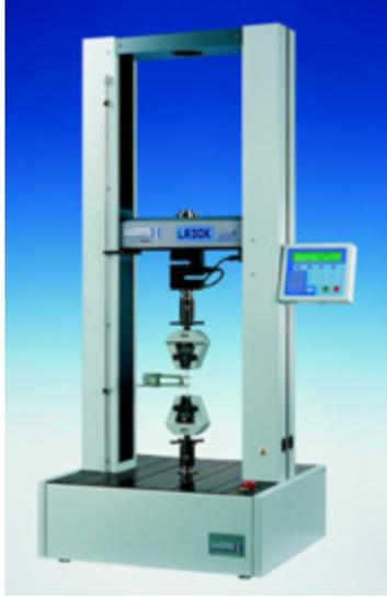
On obtient avec cet essai le graphe de l'allongement en fonction de la charge appliquée :
